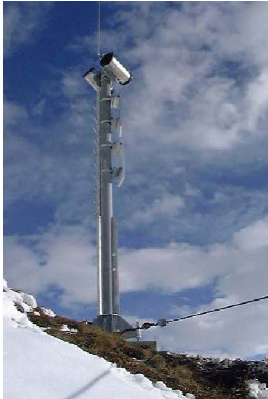
Figur 3 AlpuG Dopplerradar på toppen av målesøyle (i sylinder)
