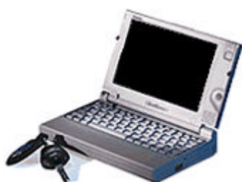
Figur 12 Eksempel på miniatyr-PC. Toshiba Libretto Modell 110CT har følgende spesifikasjoner: Ytre mål: 21 cm x 13 cm x 3,5 cm. Vekt: 1000 g. Operativsystem: Windows 98 eller Windows NT. Fargeskjerm: 7.1" aktiv matrise 800x600 punkter, 80 tasters tastatur med innebygget pekedevice ("mus") ved skjermen. Processor: 233MHz Intel Pentium MMX. Maksimum 64MB RAM, 4.3 GB disk. 16bit stereo lyd. 2.5 timers batterikapasitet. Ekstern diskettstasjon og andre eksterne tilkoblingsmuligheter gjennom påkobling av portreplikator. (Bilde og informasjon fra http://www.toshiba.com sept.1999)
